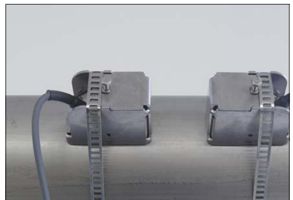
Датчики в монтажном башмаке, крепление затяжным ремнем
