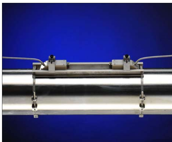
Transductores K en el riel Variofix, fijado con abrazaderas de fleje
