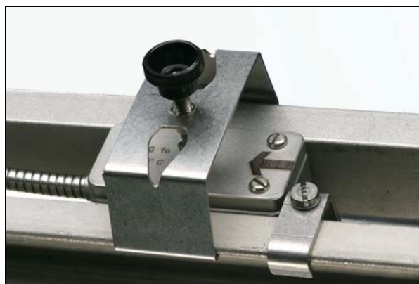
Transductores M en el riel Variofix con topes
