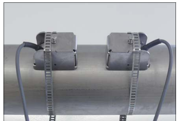
Capteurs de débit dans le support de capteur, fixé avec sangles
