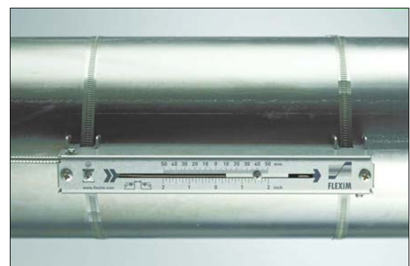
Meting met sensoren, gemonteerd met Variofix L
