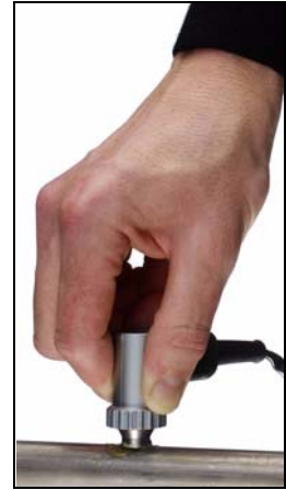
Medición de espesor de pared
